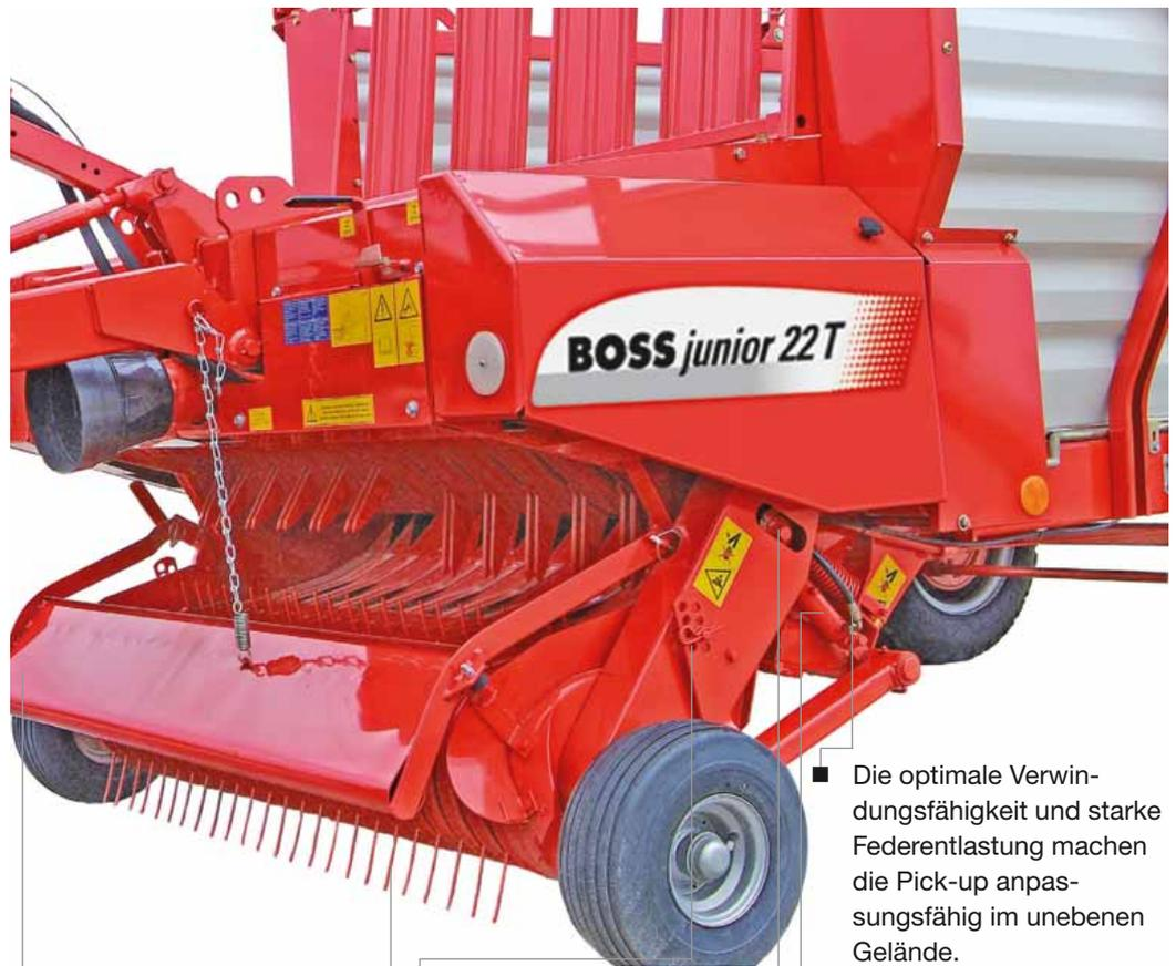
■ Nach außen gewölbte Pick-up Seitenbleche leiten jedes Erntegut zum Förderkanal. Für saubere Aufnahme bei kurzem Futter sorgt das höhenverstellbare Prallblech.
