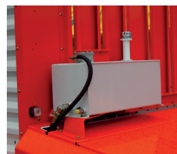
Bordhydraulik für Querförderband
