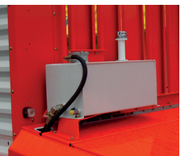
Bordhydraulik für Querförderband
