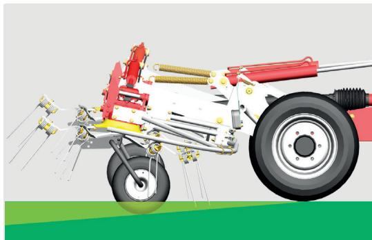
**Bei HIT 8.9 T, HIT 10.11 T und HIT 12.14 T sind alle Kreisel für perfekte Bodenanpassung mit Gelenken ausgestattet.**
