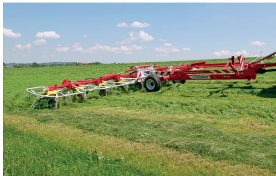
**Die gezogenen HIT T Zettkreisel mit acht, zehn oder zwölf Kreiseln sind für große Flächen konzipiert. Um dem Wunsch nach großer Arbeitsbreite bei bester Bodenanpassung gerecht zu werden, sind die Kreisel einzeln durch Gelenke miteinander verbunden. Im Zusammenspiel mit dem Fahrwerk als Kreiselführung garantieren HIT T perfekte Arbeit auch bei höheren Geschwindigkeiten.**
