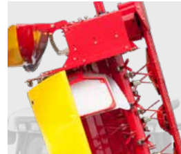
Hydraulicky sklopné stranové kryty
