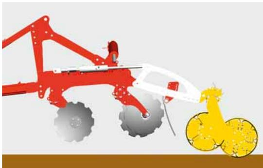
Das Fahrwerk ist in Arbeitsstellung weit nach vorne in die Position vor dem Nachläufer geschwenkt. Die gezogenen Maschinen sind weiters mit einem hydraulischen Dämpfungssystem ausgestattet und laufen daher ruhig bei der Arbeit. Die zusätzliche Belastung der Scheibenegge sorgt für sicheren Einzug bei allen Bodenverhältnissen.
