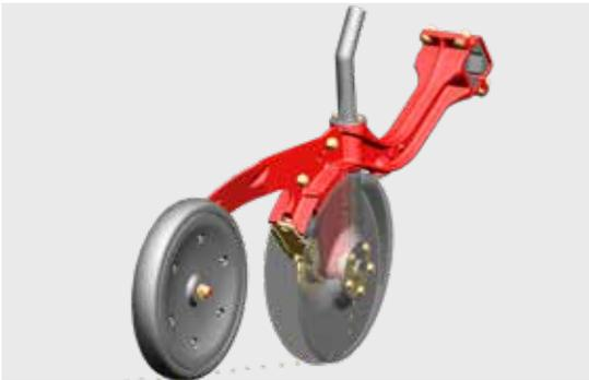
Eine gut ausgeformte und saubere Saatrille ist Voraussetzung für eine erfolgreiche Saat. Garantie für optimale Einbettung und gleichmäßigen Aufgang. Die Saatkörner werden gleichmäßig abgelegt, mit Feinerde bedeckt und von Druckrollen angedrückt.
