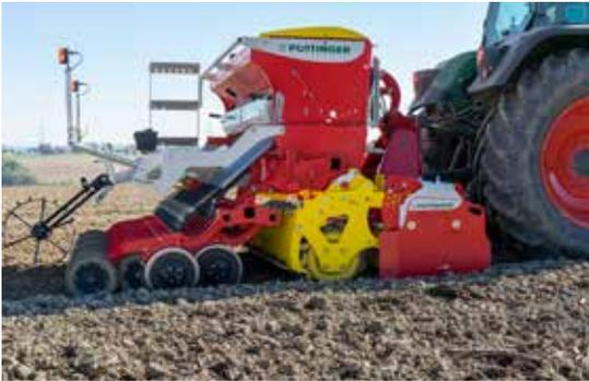
**Bei der Arbeit am Feld stützt sich die Sämaschine immer direkt auf der Walze ab. Die Kreiselegge bleibt damit frei beweglich und kann bei Steinen ausweichen.**
