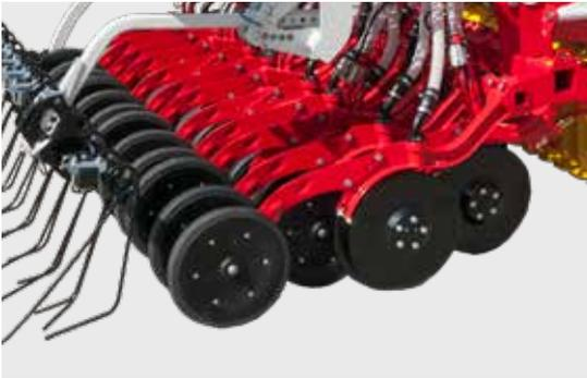
Die großdimensionierten DUAL DISC Doppelscheibenschare schneiden die Pflanzenreste durch und formen eine gleichmäßige, saubere Särille. Die Ernterückstände werden nicht in den Boden gedrückt. In Kombination mit dem innenliegenden Säelement erreicht man eine gleichmäßige, saubere Särille. Eine hervorragende Technik für den zukunftsorientierten Ackerbaubetrieb.
