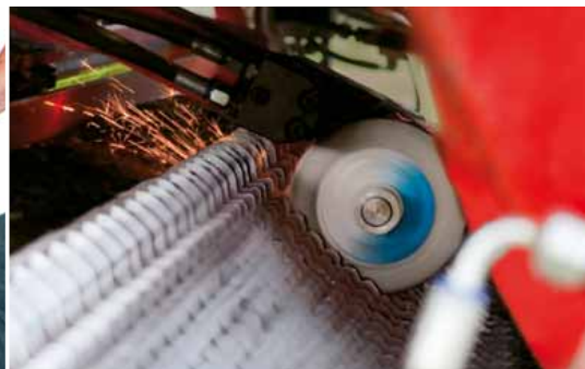
AUTO CUT - w pełni automatyczna ostrzałka do noży zamontowana bezpośrednio w przyczepie.
