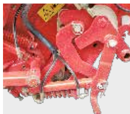
Schneidwerk hydraulisch klappbar
