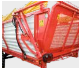
Rückwandfixierung mit Teleskopstrebe
