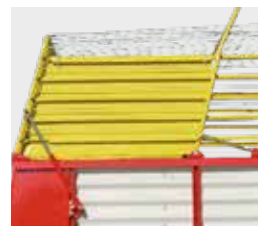
Silierbleche für Dürrfutteraufbau
