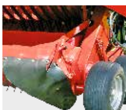
Seitliche Gummi- abdeckung für Pick-up
