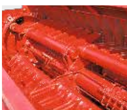
Vier Förderkämme mit Zentralschmierung
