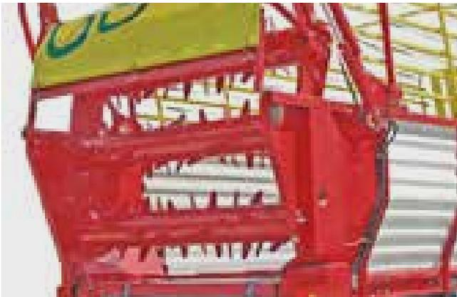
Drei Dosierwalzen garantieren eine minutenschnelle Entladung und perfekte Verteilung. Die aggressiven Zinken arbeiten auch bei hochverdichtetem Futter schlagkräftig. Ein Sensor in der Dosierwalzenlagerung schaltet den Kratzboden automatisch.
