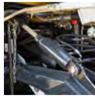
Hydraulische Knickdeichsel (gedämpft)
