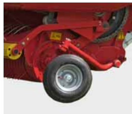
Nachlauf Tasträder für Pick-up
