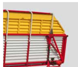
Oberaufbau Zusatzblech durchgehend
