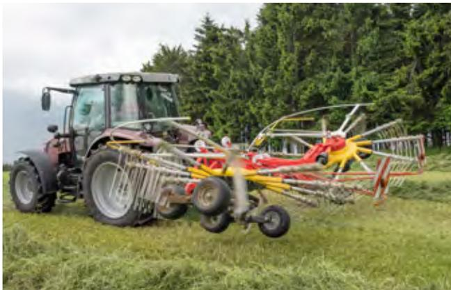
Grazie all'attacco a 3 punti con cavalletto sterzante il ranghinatore con deposito centrale dell'andana segue con precisione il trattore anche in curva. Le aste ammortizzatrici da entrambi i lati centralizzano e stabilizzano la macchina anche durante il lavoro trasversale sui pendii. Durante il sollevamento a fine campo i giranti vengono bloccati idraulicamente in posizione centrale.
