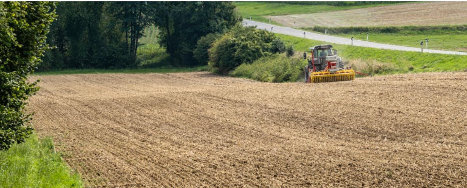
Der flexible Tank TEGOSEM kombiniert die Bodenbearbeitung und die Ausbringung von Zwischenfrüchten, Mikrogranulat oder Untersaaten in einem Arbeitsschritt, und sorgt so für Zeit- und Kostenersparnis. TEGOSEM ist sowohl mit angebauten als auch gezogenen Maschinen kombinierbar.
