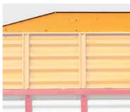
Oberaufbau-Zusatzblech zu Ganzstahlaufbau
