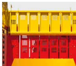
Ladeautomatikklappe hydraulisch klappbar
