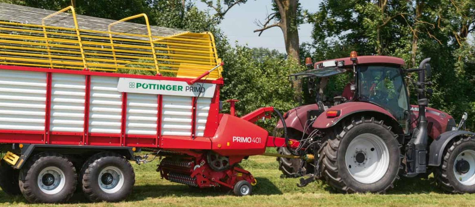
**Der Antriebsstrang ist für hohe Leistungen konzipiert. PRIMO Ladewagen sind für Traktoren bis 130 PS ausgelegt.**
