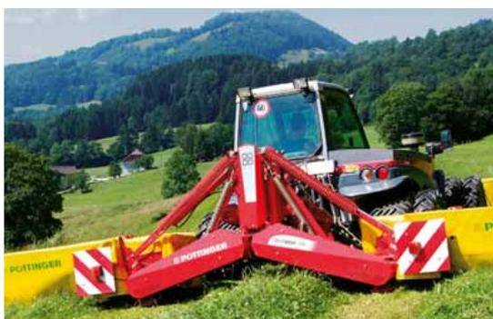
**Le falciatrici combinate NOVADISC coprono il settore del mercato delle macchine senza condizionatore. Il marchio di fabbrica è la costruzione leggera con sospensione laterale.**
