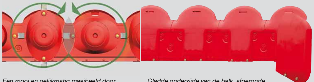
Een mooi en gelijkmatig maaibeeld door een geoptimaliseerde overlapping van de messenbanen.
