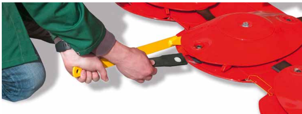
Prosta i szybka wymiana noży
