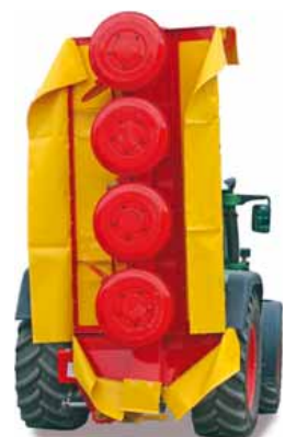
Schwenkung nach hinten und hoch: Das Mähwerk ist nahe am Traktor und bewirkt dadurch eine geringere Vorderachs-Entlastung.
