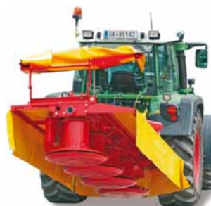
Schwenkung nach hinten: Für niedrige Durchfahrten wird das Mähwerk nach hinten abgesenkt, darf aber nicht als Dauer-Transportstellung verwendet werden.
