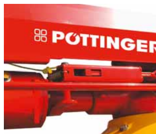
Mechanische Schrägstellung – HIT NZ – einfach über Seilzug vom Traktorsitz.
