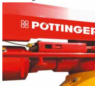
Marche oblique centralisée mécanique (HIT NZ) par simple traction sur une corde depuis le siège du tracteur.
