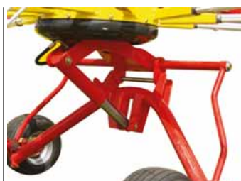
En enkeltvirkende cylinder løfter 421 A, 461 A, 601 A, 611 A, 691 A
