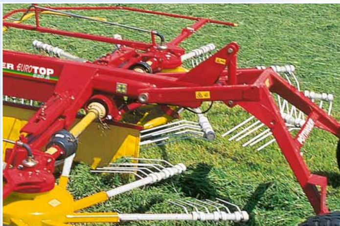
Hydraulisk rammeløft på EUROTOP 620 A
