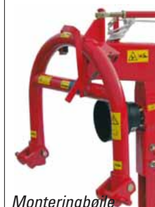
Monteringsbøjle med påmonteret stangforbindelse er standart på 651 A, 801 A, 851 A, 701A, 771 A, 881 A,
