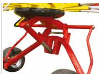
Гидравлический подъем простого действия через копирующие колеса 421 A, 461 A, 611 A и 691 A.
