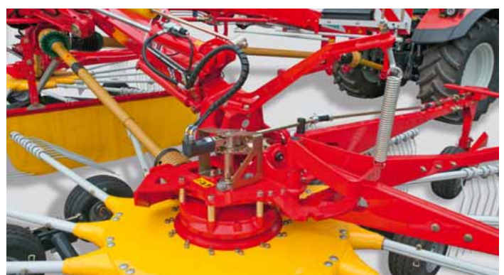
Réglage hydraulique de la hauteur des rotors
