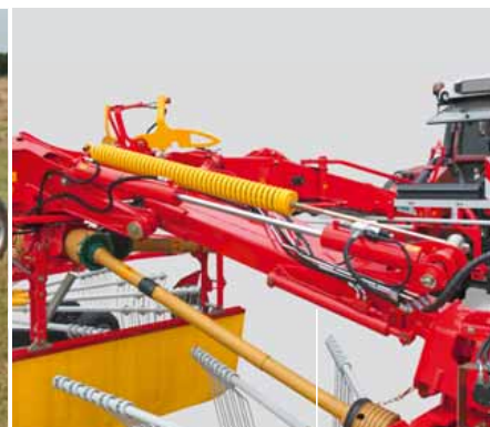
Réglage hydraulique de l'andain
