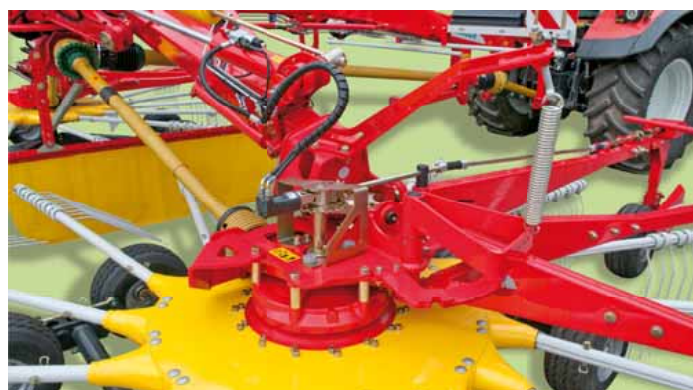
Ajuste hidráulico de la altura del rotor
