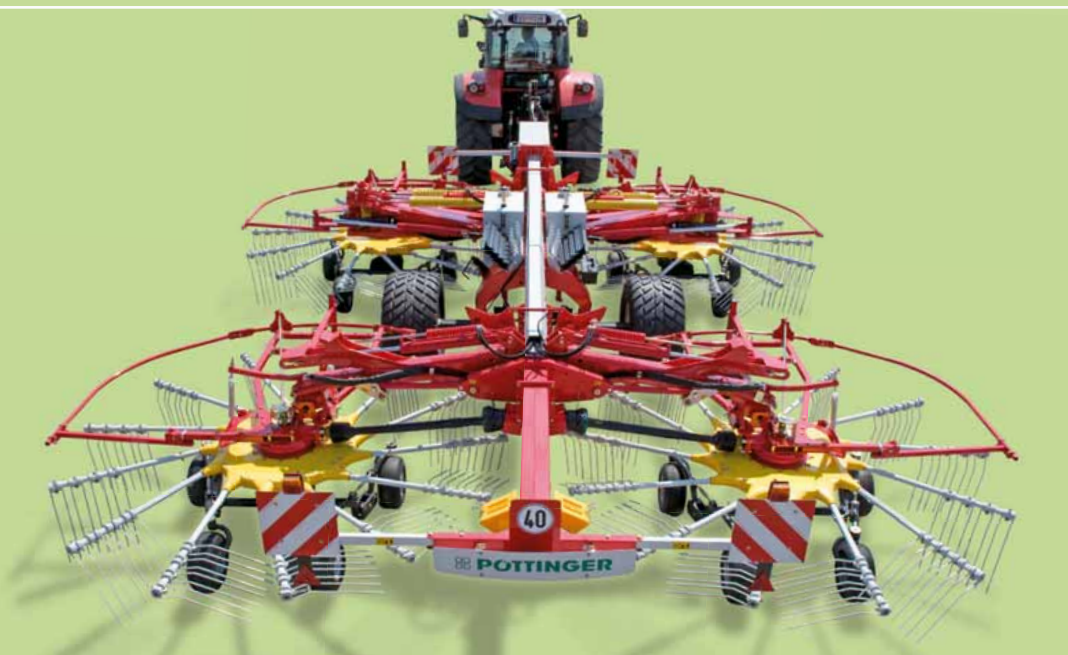
Einschwenken eines vorderen Kreisel zum Umfahren von Hindernissen
