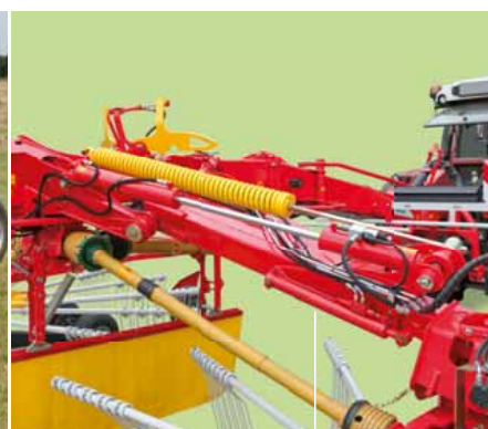
Ajuste hidráulico del ancho de hilera
