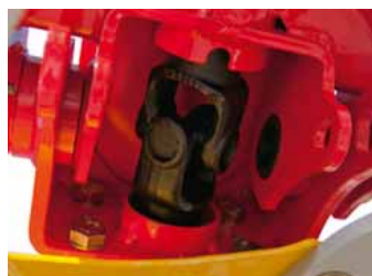
Giunti cardanici semplici e doppi con lubrificazione a vita
