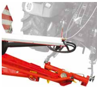
Wskaźnik kąta skrętu na wahaczu zaczepu
