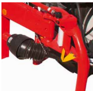
Wskaźnik kąta skrętu na ramieniu rurowym
