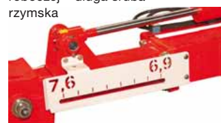
Regulacja szerokości roboczej – wskaźnik
