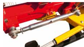
Regulacja szerokości roboczej – długa śruba rzymska
