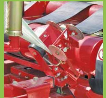
Automatische Folien-Klemm- und Schneideinrichtung
