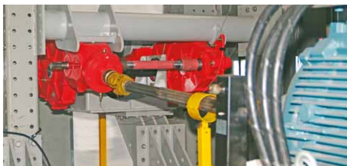
Sprawność i wydajność elementów napędowych jest badana w trakcie specjalnego testu.
