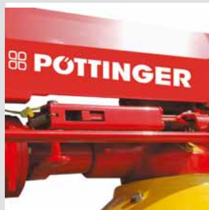
Mechanische Schrägverstellung bei HIT 610 NZ. Durch Seilzug einfach vom Schleppersitz bedienbar.
