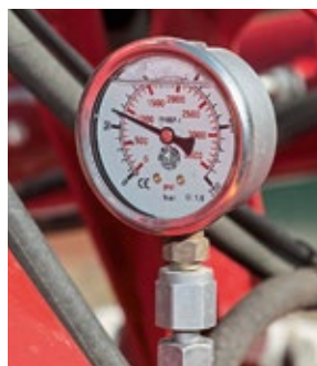
Der Zylinder mit zwei Kolbenstangen sorgt zusammen mit der Stickstoffblase für eine geniale Dämpfung – die Terradisc liegt so wie ein Brett. Das Manometer erlaubt die Kontrolle.
