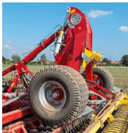
Das Fahrwerk wird bei der Arbeit über die Maschine geklappt. Das begünstigt den Einzug und die Fahrstabilität bei der Arbeit.
