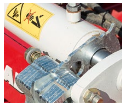
Die schwenkbaren Anschläge ermöglichen die Tiefeneinstellung. Vorbildlich: Die Anschläge berühren die Kolbenstange nicht.
