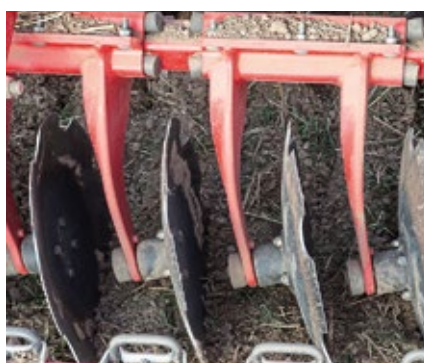
An jeder der geschmiedeten Aufhängungen sind immer zwei Scheiben aufgehängt. Die Stiele sind sehr massiv.
