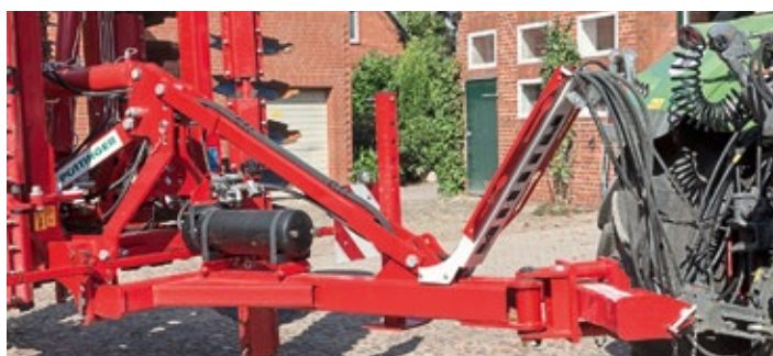
Der Anbauraum ist aufgeräumt, die Schlauch- und Kabelführung hat Pöttinger wesentlich verbessert. Die Anbautraverse verdreht sich beim Anbauen nicht.
