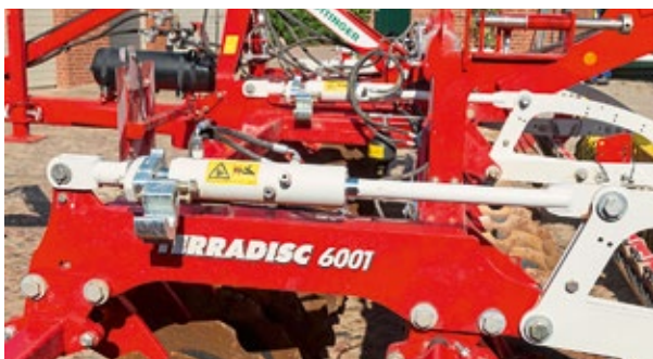
Der Zylinder mit zwei Kolbenstangen sorgt zusammen mit der Stickstoffblase für eine geniale Dämpfung – die Terradisc liegt so wie ein Brett. Das Manometer erlaubt die Kontrolle.
