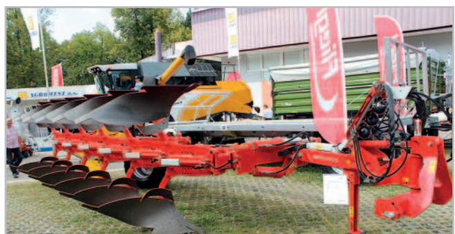
K zajímavým finesám polonesených pluhů Servo 6.50 firmy Pöttinger patří nejenom možnost vyřadit první orební těleso ze záběru povelém z kabiny traktoru, ale také řízený trakční posilovač Traction-Control. Jeho působením je dotěžováno záhonové kolo zadní nápravy traktoru, které je za běžných podmínek výrazně odlehčené
