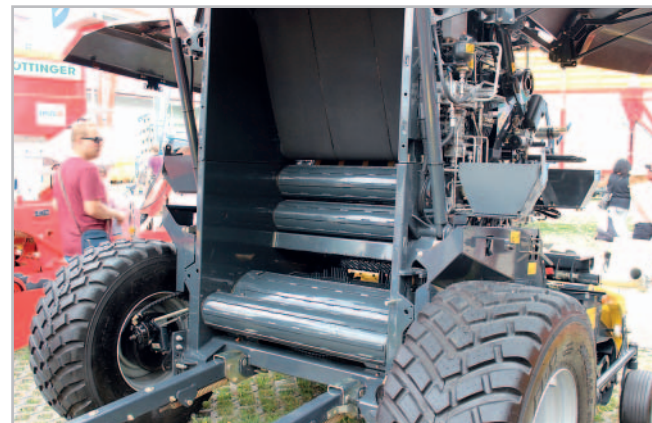
Vhodně připravený exponát lisy dal nahlédnout dovnitř lisovací komory na startovací válece a na trojici širokých nekonečných řemenů. Byl také patrný přímý pohyb hmoty plnicím ústrojím do komory
