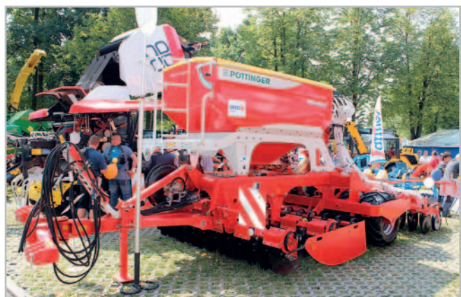
Pneumatický secí stroj Terrasem R3 prezentoval klasickou verzi s krátkými talířovými branami pro předsetovou přípravu, nicméně v České republice byl v létě úspěšně uveden do provozu i secí stroj Terrasem C6 se sekci Wave disc. Tato varianta využívá koltrů pro zpracování půdy v pruzích s roztečí secích botek
