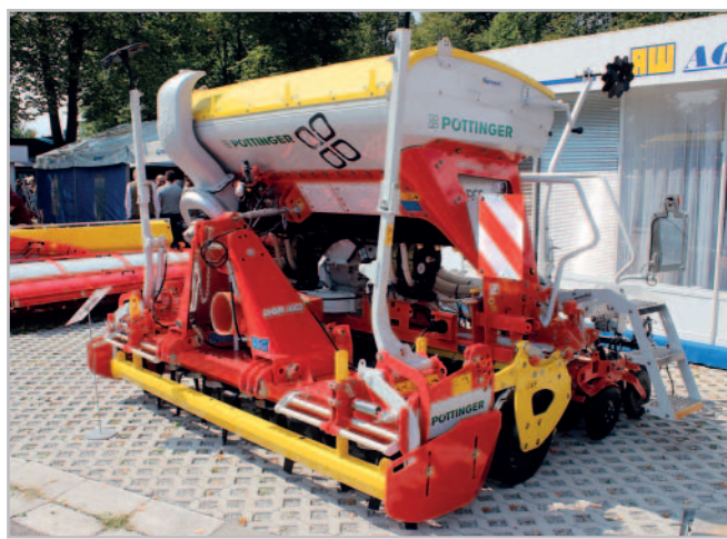
Pneumatický secí stroj Aerosem ADD v provedení se systémem PCS a hlavicí IDS umožňuje nejen klasické úzkorádkové setí, ale také přesné setí řepky či zakládání porostů širokorádkových plodin (kukuřice, slunečnice) včetně přihnojení nebo setí podsevu
