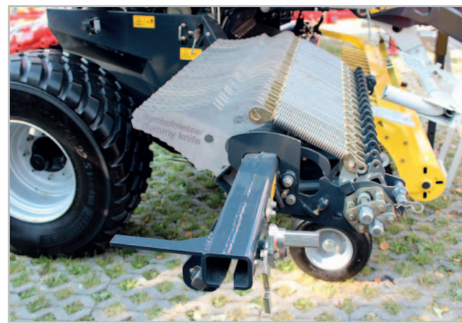
Dělený nosník s noži lze vysunout do strany, a potom pootočením řadičím hřídelem polovinu nožů zasunout dovnitř a v kanále nechat v záběru jen 16 nožů. Vše se provádí pohodlně vestoje bez nutnosti zasahování do prostoru lisovací komory
