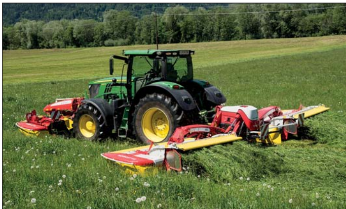
Spolu s 3 m čelným žacím strojom je pracovný záber kombinácie nastaviateľný od 8,80 do 9,56 m. S 3,5 m strojom od 9,26 do 10,02 m.
