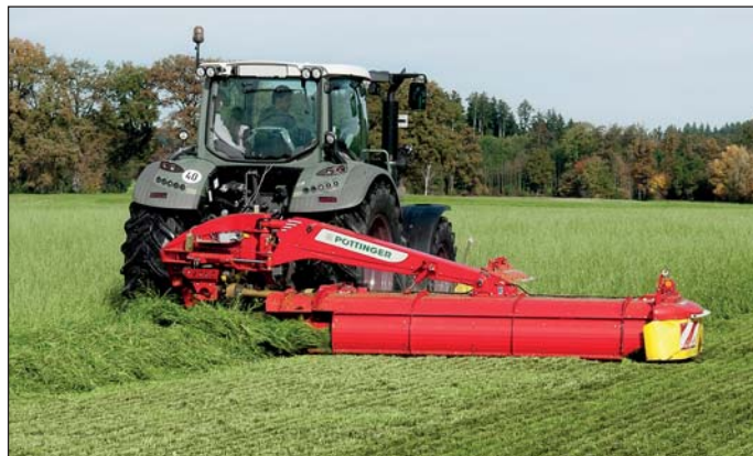
Priečny šnekový dopravník odoberá hmotu priamo od žacích diskov a mení smer jej pohybu o 90 stupňov, pričom bez dotyku s pôdou ju ukladá na zdvojený riadok.
