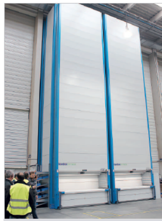
Výškový skládací systém dokáže na velmi malé ploše uskladňovat až 65 t materiálu
