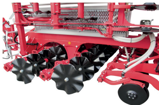
Systém Wave disc je tvořen talíři o průměru 510 mm v rozteči 12,5 anebo 16,7 cm. Přítlak na každý talíř může činit až 100 kg
