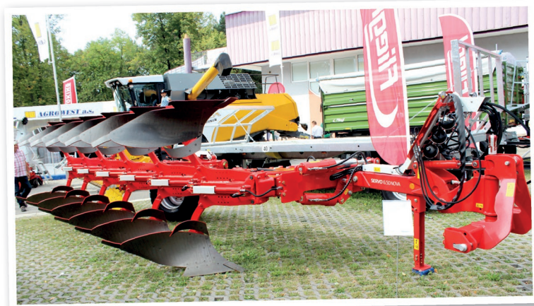
K zajímavým finesám polonesených pluhů Servo 6.50 firmy Pöttinger patří nejenom možnost vyřadit první ořební těleso ze záběru povelom z kabiny traktoru, ale také řízený trakční posilovač Traction-Control. Jeho působením je dotěžováno záhonové kolo zadní nápravy traktoru, které je za běžných podmínek výrazně odlehčené
