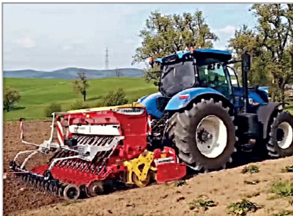
Systém s kamerou firmy Pöttinger měří přímo a za jízdy soupravy traktoru s rotačními bránami hrubost povrchu půdy
