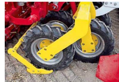
Das Fahrwerk mit Tandemeffekt verhindert ein Aufschaukeln der Maschine auf unebenen Flächen.
