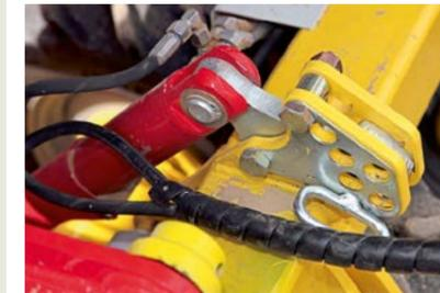
Die Arbeitstiefe der federbelasteten Messerschneide kann über ein Lochraster verstellt werden.
