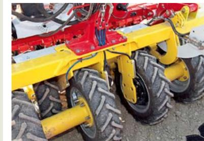
An den vier inneren Rädern sind Trommelbremsen angebracht, die jeweils auf eine der vier Achsen wirken.
