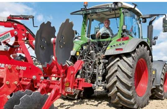
Jeweils die beiden äußeren Scheiben der Terradisc werden hydraulisch eingeklapp.
