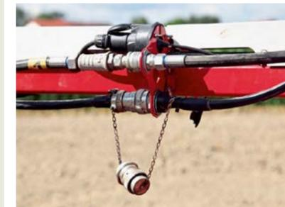
Alle Kabel- und Schlauchverbindungen der Sämaschine werden am oberen Rahmen der Multiline gekuppelt.
