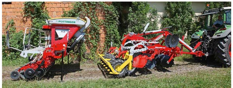
Ein geübter Fahrer benötigt keine fünf Minuten, um die Maschinen zu trennen. Auch das Anbauen der Drillmaschine stellt dank guter Sicht auf die Koppelpunkte kein Problem dar.
