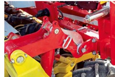
Die Koppelpunkte sind an den Rahmen der Sämaschine geschraubt. Zum Abkoppeln muss nur ein Bolzen umgesteckt werden.
