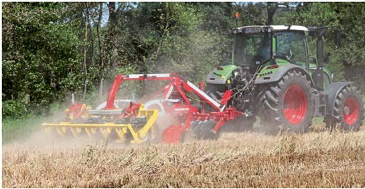
Ohne Drillmaschine ist die Terradisc auch zur Stoppelbearbeitung einsetzbar.
