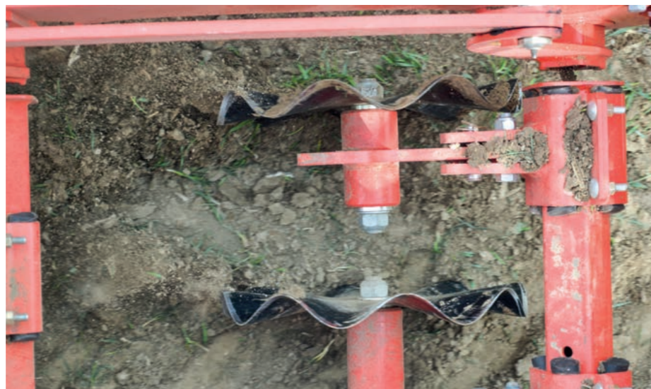
System WAVE DISC sprawdza się w każdych warunkach – uprawa i późniejszy siew możliwe są zarówno na stanowiskach o dużej wilgotności gleby, jak i na bardzo suchych.
