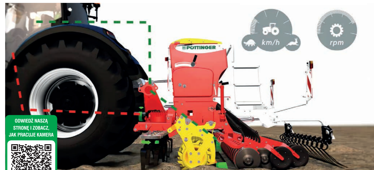
Praca z kamerą pozwala na optymalnie przygotowanie gleby do siewu. Operator ma większy komfort pracy, ponieważ nie musi stale się odwracać, aby kontrolować strukturę gleby i ręcznie dopasowywać obroty wirników i prędkość jazdy.
