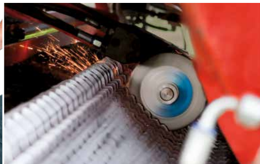
AUTO CUT – Vollautomatische Messerschleifeinrichtung direkt am Ladewagen.
