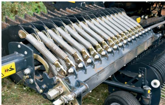
Nosník nožov sa ľahko vysúva na pravú stranu pre pohodlnú výmenu nožov s obojstranným ostrím. Na zaistovanie a odistovanie nosníka aj nožov stačí jedna montážna páka. Vpravo poloha s polovičným počtom aktívnych nožov. Pružiny sa pri vniknutí kameňa nestláčajú, ale ohýbajú.
