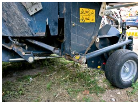
Pomocou dorazov na pieste možno zberač pre ešte šetrnejší zber úplne zdvihnúť (bez kontaktu kopírovacích kolies so zemou).
