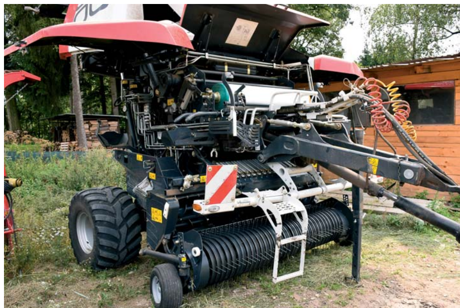
Odstrojený pohľad na prednú a pravú časť lisu s vedením hydraulických hadíc a snímačmi.
