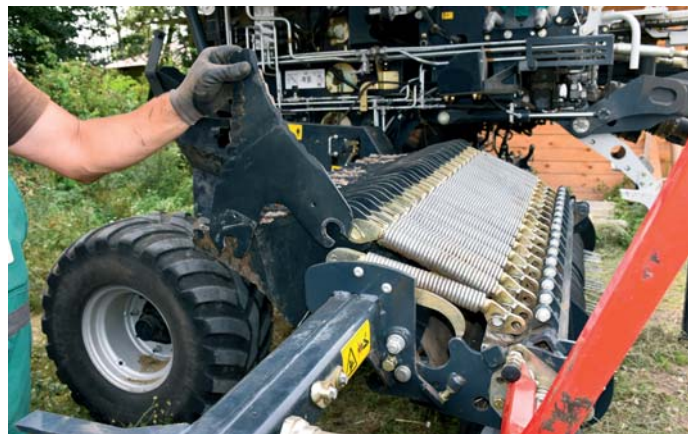
Nosník nožov sa ľahko vysúva na pravú stranu pre pohodlnú výmenu nožov s obojstranným ostrím. Na zaistovanie a odistovanie nosníka aj nožov stačí jedna montážna páka. Vpravo poloha s polovičným počtom aktívnych nožov. Pružiny sa pri vniknutí kameňa nestláčajú, ale ohýbajú.
