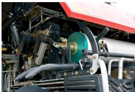
Zavádzanie siete je automatické, nad počtom ovití balíka dohliada snímač.
