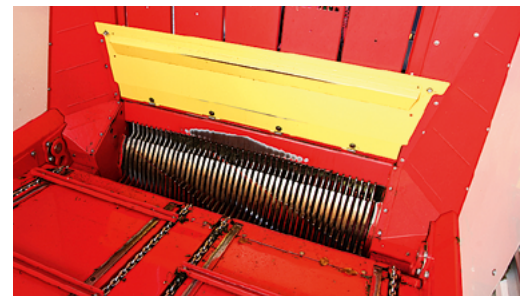
Der Kratzboden ist um 15 cm abgesenkt, es gibt zwei Plattformhöhen und eine Kanalabdeckung.
