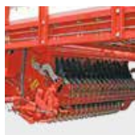
Řezací ústrojí s 31 noži
