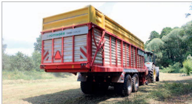
Nová multifunkční zadní stěna je namísto plachty vybavená plechovým zakrytím, které zabraňuje ztrátám materiálu v průběhu přejezdů
