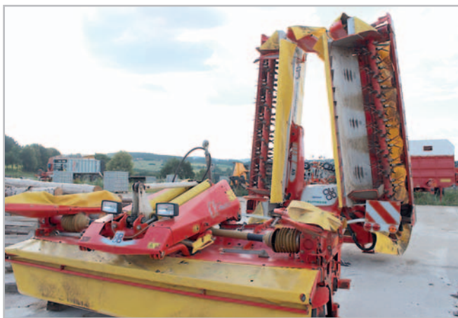
S žací kombinací A9 ED dokážou zkušené obsluhy z Bražné posekat za 8–10 hodin 50 hektarů při spotřebě pouhých dvou až tří litrů nafty na hektar
