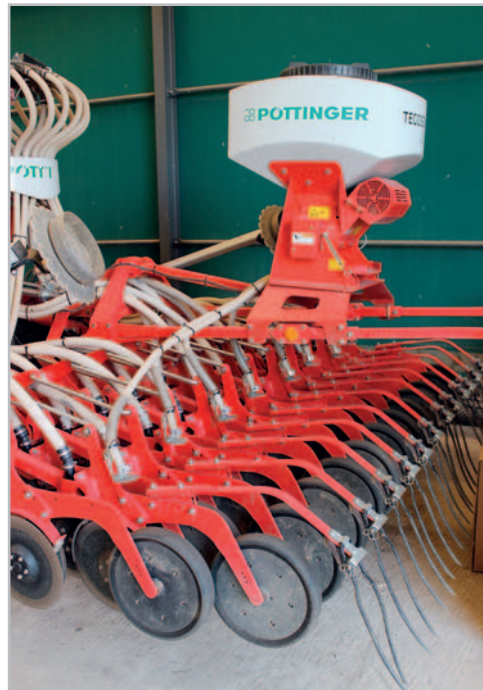
Výsev krycí plodiny a zároveň i podsevu při jednom přejezdu dokáže zabezpečit sečí stroj Tegosem 200. Vývody s rozrážecími plechy jsou uloženy v prostoru sečí botek; zásobník pojme 200 l osiva
