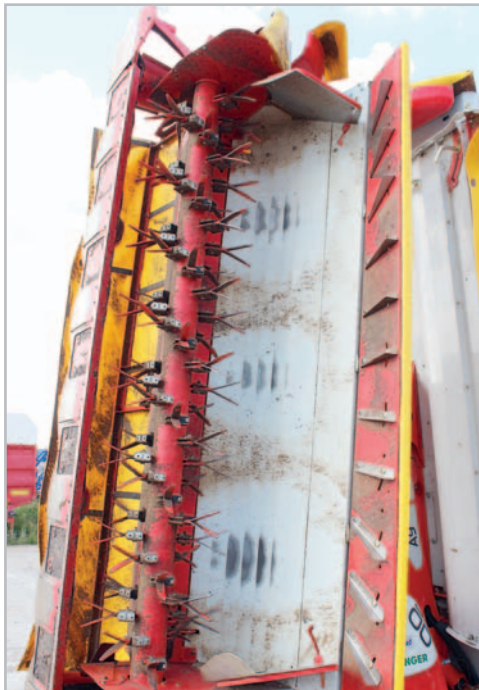
Hmota je rotorem kondicionéru s prsty z kalené oceli dopravována přes plechy, konstruované tak, aby rozhazovaly píci po celém pracovním záběru. Prsty jsou uspořádány spirálově pro rovnoměrné zatížení; každou lamelu lze individuálně nastavit
