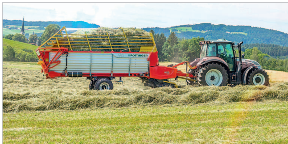
Sběrací vůz Pöttinger Boss 3000 je vybaven klasickým hrabicovým vkládacím ústrojím Supermatic
