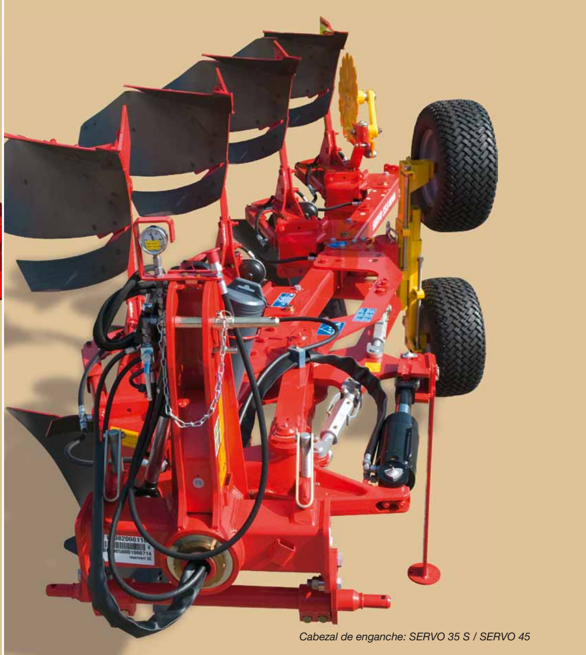
Regletas interiores atornilladas en la zona de mayor esfuerzo del bastidor
