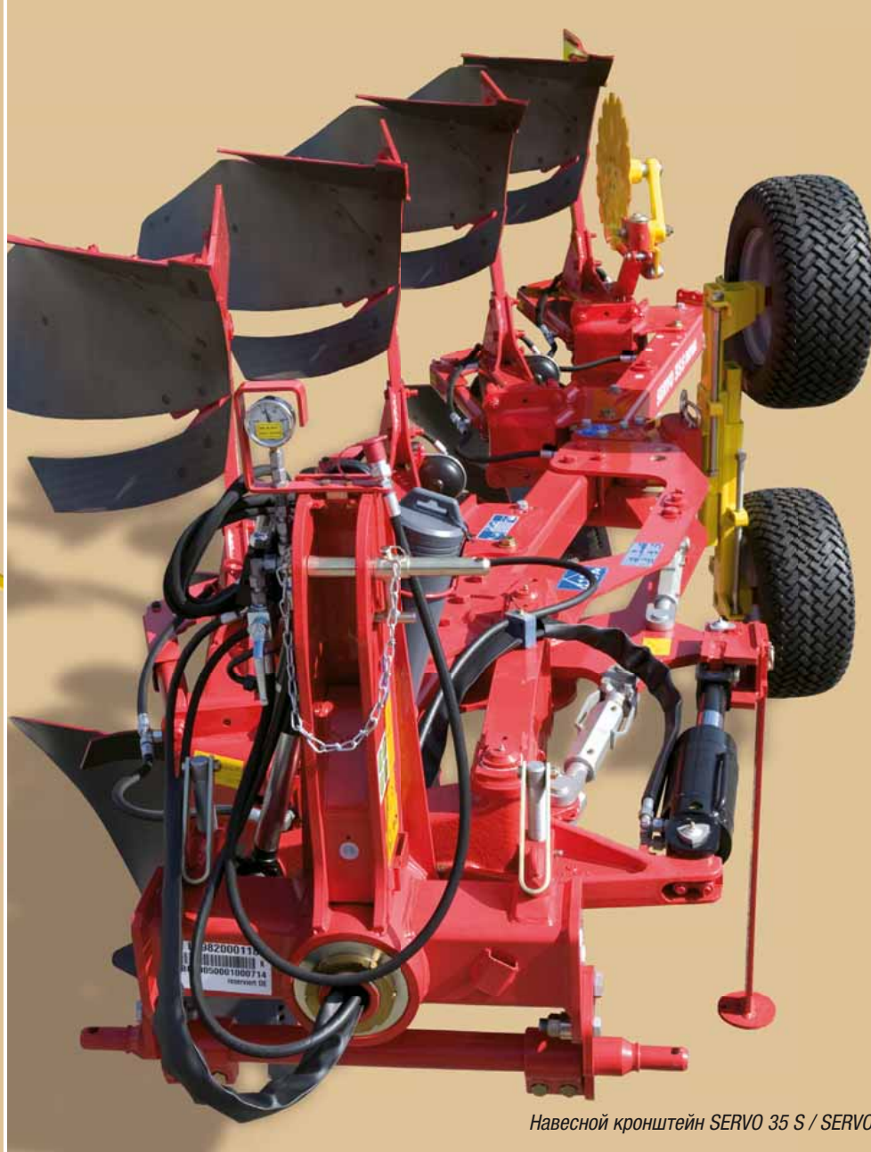
Уникальные соединительные планки в местах максимальной нагрузки на раму
