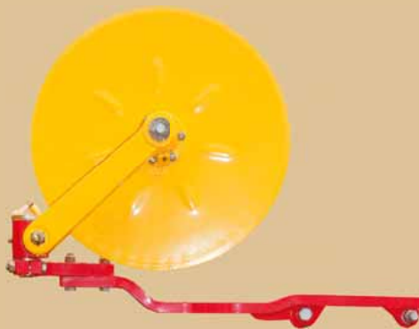
Kiekkoleikkuri: sileällä tai hammastetulla kiekolla.
