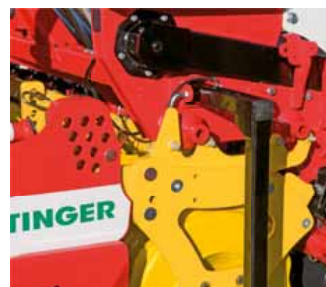
Unter Sämaschine fahren – Kreiselegge anheben
